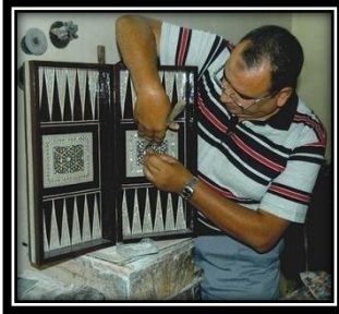
شكل (٣ - ظ) يمثل مرحلة تثبيت وسنفرة الأشكال الصدفية الزخرفية لطاولة لعب النرد
